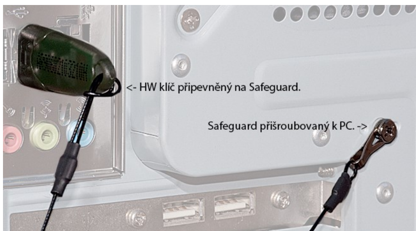
Safeguard připevněný k zadní části PC pomocí šroubku.
