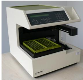
*Fig. 1: Kontron 460/465 autosampler*
