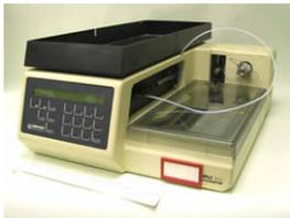
*Fig. 1: Kontron 360/560 autosampler*
