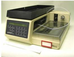
*Fig. 1: Kontron 360/560 autosampler*
